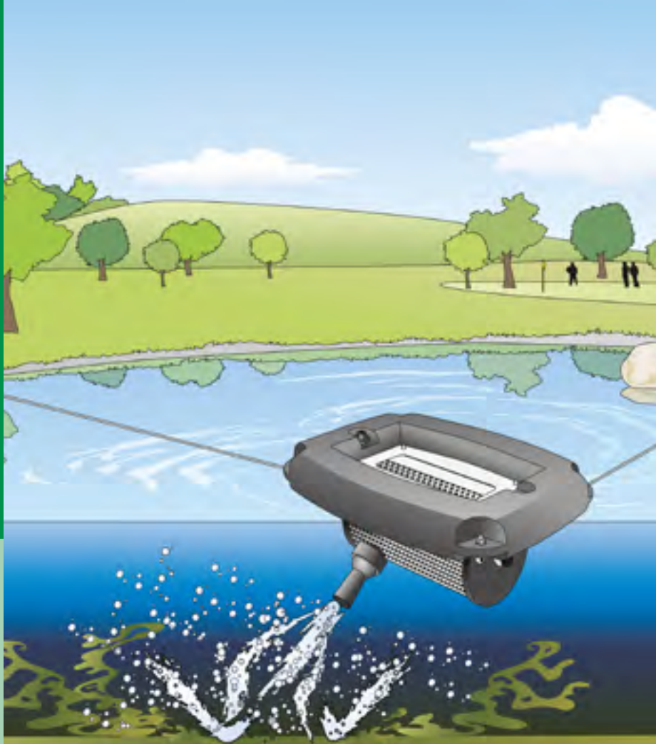
Схематическая диаграмма: Использование аэатора для пруда AquaAir 250 – оптимальное распределение кислорода в пруду
